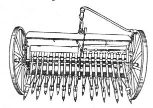
Die Maschine zieht Rillen in den Boden und lässt die Körner gleichmässig in die
