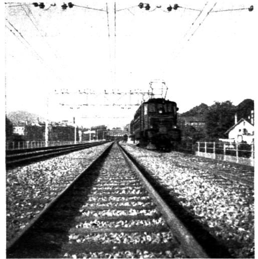
Die erste elektr. Lokomotive auf der neuen Strecke Wylerfeld-Bern. Probefahrten mit verschiedenen Geschwindigkeiten.
