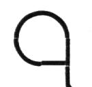
Griffe: Nur aus bemaltem Eisenblech. Wärmeleiter! Keine solide Befestigung.
