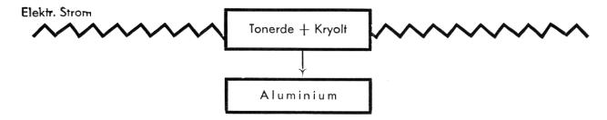
Teil: Die elektrische Gewinnung des Aluminiums aus der Tonerde-Elektrolyse. Schweizerische Arbeit.
