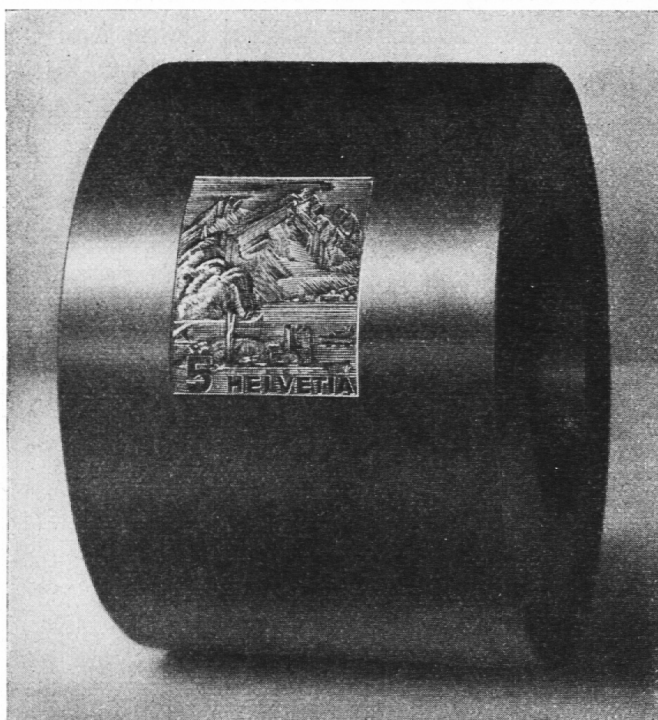
Stahlmolette mit einem positiv geprägten Markenfeld
