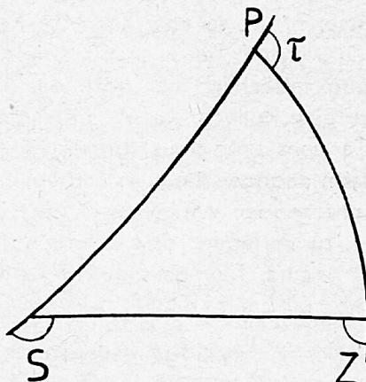
ihnen gebildete Aussenwinkel bekannt:  $PZ = 90^\circ - \varphi$ ,  $PS = 90^\circ - \delta$  und der Aussenwinkel bei P (= Stundenwinkel  $\tau$ ). Um den Aussenwinkel bei Z (d. h. das Azimut der Kirchenachse) zu finden, bedienen wir uns der sog. Napier'schen Analogien, aber in ihrer streng dualistischen Form, in der statt der Innenwinkel die Aussenwinkel verwendet werden. Sei S der dritte Aussenwinkel des Dreiecks, so kommt
