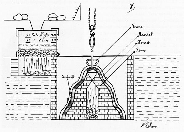
wird aus harten Kaminsteinen der Kern aufgebaut, der dem »Hohlraum der zu giessenden Glocke entspricht. Hervorstehende Ecken werden abgeschlagen. Der Kern kann um seine Achse gedreht werden. Ein Arbeiter überstreicht diesen mit Lehm und flüssigem Talg, damit die weitern Formen, die darüber gestülpt werden, mit dieser ersten nicht zusammenkleben.
