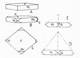
Fig. 15. Einfachste Barytkombinationen. A und B in schiefer Parallelprojektion. C = Kopfbild, D = Vorder-, E = Seitenansicht der Kombination B.
