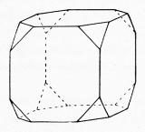
Fig. 7. Ent-eckter Würfel (Galenit, Fluorit).
