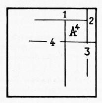
Fig. 5. Spaltrisse auf einer Würfelfläche von Steinsalz.
