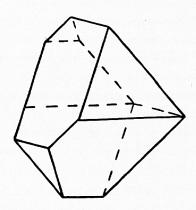
Fig. 3. Verzerrtes Oktaeder (Fluorit, Magnetit).
