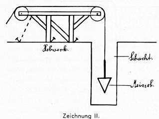
An die Stelle des Meissels kam nun ein 2—3 m langes Blechrohr. Dieses Rohr ist am Boden mit einer einwärtsgehenden Klappe versehen. Kommt es unten an, so öffnet sich die Klappe, und der Brei dringt ein. Zieht man auf, so schliesst sie sich wieder, und die eingedrungene Flüssigkeit wird zu Tage gefördert. —
