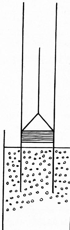
den Kolben empor, steigt das Wasser nach, nicht weil der Kolben es an sich reisst, sondern
