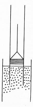
den Kolben empor, steigt das Wasser nach, nicht weil der Kolben es an sich reisst, sondern einen luftleeren Raum herstellt, der ausgefüllt werden sollte. Mit einer solchen Pumpe versuchen wir das Wasser aus der Grube hoch zu bringen. Wird es wohl gehen?
