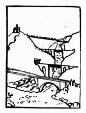
Die Kehrtunnels reduzieren das Maximum der Steigung auf 26 Promille. Mit was sind die Rehrtunnels vergleichdar? Bergtour: Zidzadwege. Zahnrad. Größerer Tunnel: Schon vor Wassen beginnend. Dann wäre aber Göschenen seine Station. Sandkasten mit Relief der Kehrtunnels. Erklärung desselben durch die Kinder. Bergleich mit dem Kartenbild und der Zeichnung. Erster Kehrtunnel Pfaffensprung; Hauptsehr Wassen; weitere zwischen Umbri und Faido; Giornico.
