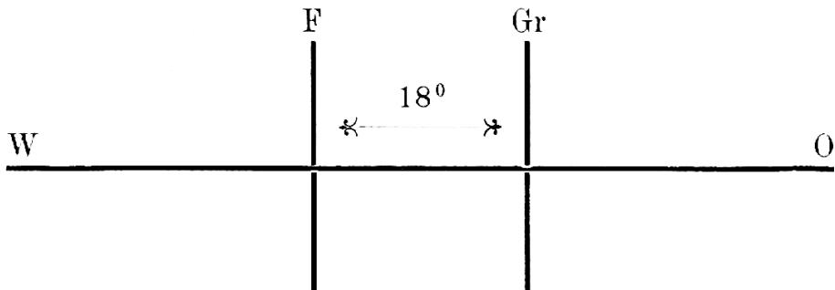
Der mit F bezeichnete Strich bedeutet den Nullmeridian von Ferro; der mit Gr bezeichnete bedeutet den Nullmeridian von Greenwich. Diese beiden liegen um (beiläufig)  $18^{\circ}$  auseinander.
