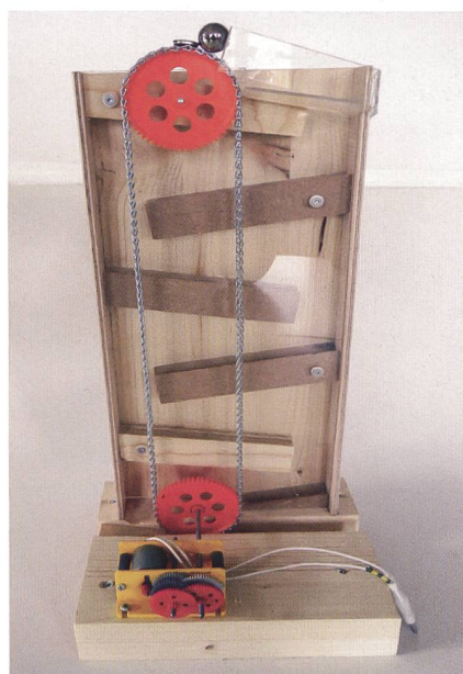
Abb. 8: Ein Kugellift mit Zahnradkette, starken Magneten und einem Getriebemotor.
