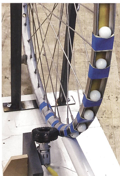
Abb. 6: Fördersysteme können z.B. mit einem Velorad konstruiert werden.
