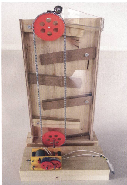
Abb. 8: Ein Kugellift mit Zahnradkette, starken Magneten und einem Getriebemotor.
