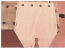
17. Kanten der Holzplatte mit Schleifpapier und Schleifklotz feinschleifen.
