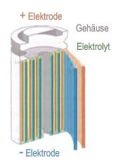
Schematische Darstellung einer gewickelten Akku-/Batteriezelle.
