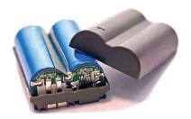
Geöffnetes Akkupack mit Überwachungselektronik.
