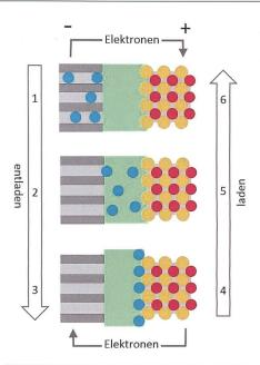
Graphitschicht Elektrolyt Negative Elektrode: Li-Atome sind im Graphit eingelagert, wenn der Akku geladen ist (1). Positive Elektrode: Li-Ionen sind am Metalloxid angelagert, wenn der Akku entladen ist (4).
