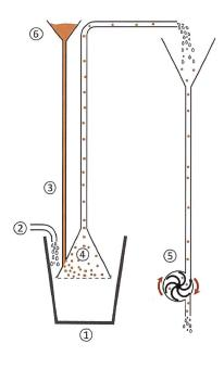
**Abb. 3:** Funktionsprinzip eines Osmosekraftwerkes (vgl. A4).
