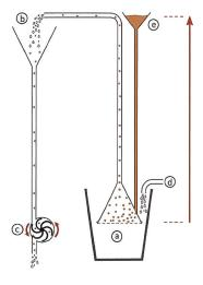
Weil die Salzlösung unter demselben Druck nachgefüllt werden muss wie im Osmosetrichter, wird sie im Schema auf derselben Druckhöhe dargestellt.
