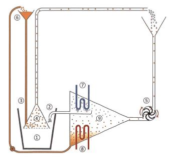
**Abb. 1:** Geschlossener Osmosekreislauf als Grundlage für eine Wärmekraftanlage.
