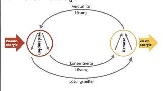
Abb. 3: «Umkehrung» der Osmose durch Wärme.
