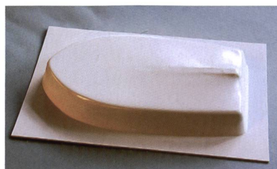
Die Patrizie des Bootsrumpfes, über welche die weiche Folie gezogen wird.
