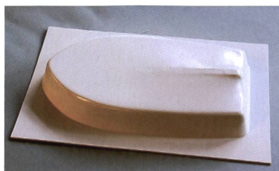
Der fertige Rumpf nach dem Ausformen, die Kanten müssen noch mit der Blechschere oder der Laubsäge zugeschnitten werden.
