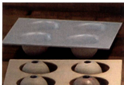
Aus Polystyrol tiefgezogene Pralinenformen mit der zugehörigen Form.
