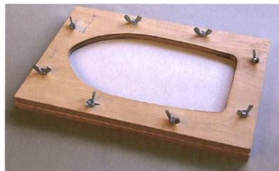
Der Spannrahmen für die Polystyrolfolie.
