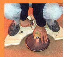
Achte auf leichte Bauweise und saubere Achslagerung. Die Räder sägst du aus Wellkarton mit der Kreissägehilfe. Teste und verbessere immer wieder, indem du z.B. die Laufflächen der Räder mit einem Papierstreifen abdeckst, einen Tropfen Öl am richtigen Ort anbringst usw.
