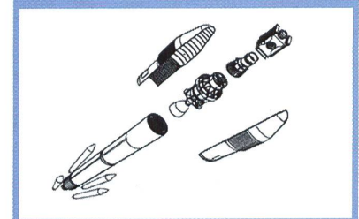
Dieser Satellit – die Solarpanels entfalten sich erst im Orbit – muss mit einer Träger-rakete in Umlauf gebracht werden. Er ist im obersten Teil der Träger-rakete unterge-bracht. Die Rakete hat verschiedene Stufen mit Triebwerken, Treib-stofftanks und Verklei-dungen, die nach und nach abgeworfen werden (siehe unten). Nach dem Freisetzen der Nutzlast ist die Aufgabe der Träger-rakete beendet.
