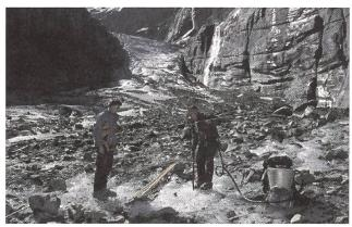
Abb. 3.7 Glaziologen der Universität Zürich bohren mit heissem Wasserdampf tiefe Löcher in das Eis des Oberen Grindelwaldgletschers. Darin werden später Pegelstangen zur Messung der Schmelzrate (Ablation) im Zungenbereich versenkt und ein Jahr später abgelesen. (Foto: Horst Machguth, 2003)
