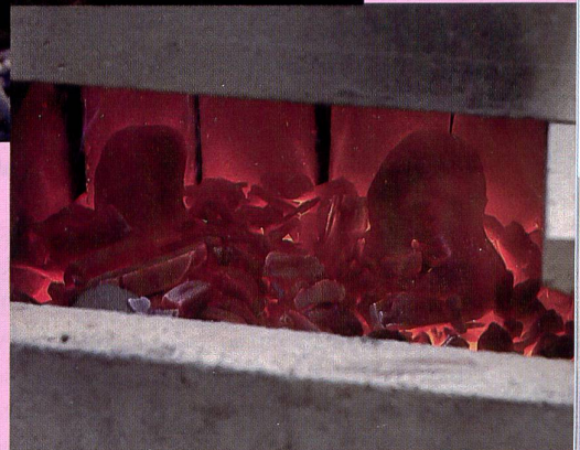
■ Ein Blick in den Ofen: Die Giess- formen werden langsam bis ≈ 1200 °C auf- geheizt.
