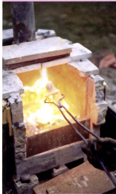
■ Ein «heisser» Moment: Die glühende Form wird dem Ofen entnommen und gegossen.
