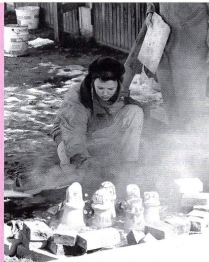
■ Die Gussformen stehen in einem Holzkohlefeuer zum Wachs ausschmelzen.
