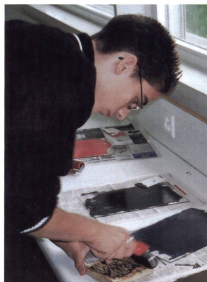
Der Druckstock wird mit der dritten Farbe eingefärbt.
