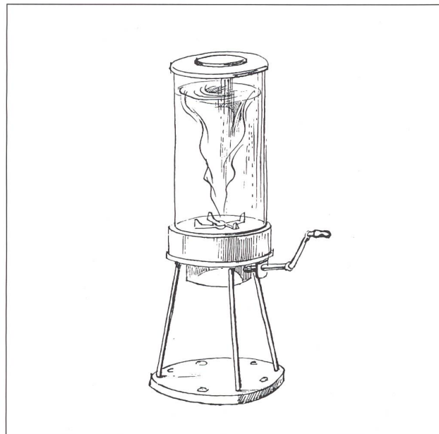
Ein Zylinder aus Plexiglas (40 cm Ø, 80 cm hoch) enthält ein Rührwerk, das durch eine Handkurbel über ein Getriebe in Drehung versetzt wird. Das Gerät, das mit seinem Ständer fest am Boden verankert ist, hat die Gesamthöhe von 1,50 m. Zu etwa einem Drittel ist der Zylinder mit Wasser gefüllt.
