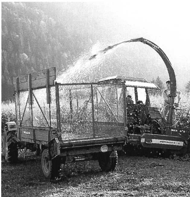
Der Mais als Futterpflanze hat bei uns eine zunehmende Bedeutung erlangt. Schon auf dem Feld wird die Ernte silogerecht verhäckselt.
