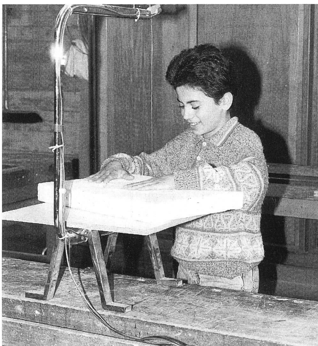
Aussägen der Betongussform mit Thermosäge
