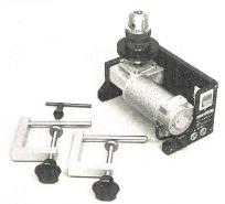
Experimentierantrieb 0-30 VDC
