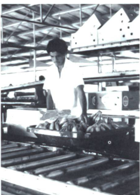
20 Schliesslich erfolgt das Abfüllen der Bananen in mit Plastik ausgeschlagenen Schachteln. Das im Vordergrund sichtbare Fliessband endet direkt in einem Güterwagen der plantageneigenen Eisenbahn.
