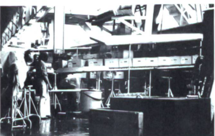
23 Auf Rollenstrassen gleiten die Bananenkisten auf einen Gabelstapler, der in die Lagerräume des Schiffes führt. Der im Bild gezeigte Verlad findet in der Regel nachts statt, unmittelbar nach dem Pflücken, damit die Früchte nicht vorzeitig reifen. Im Schiff selbst werden die Bananen kühl gelagert. Eine Verzögerung im Produktionsablauf bewirkte, dass das hier gezeigte Verladen erst tags darauf erfolgen konnte.
