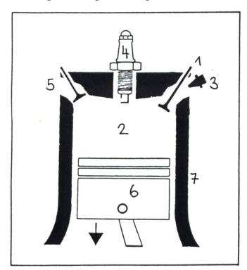
1. Einlassventil, 2. Verbrennungsraum, 3. Einspritzdüse, 4. Kerze, 5. Auslassventil, 6. Kolben, 7. Zylinder
