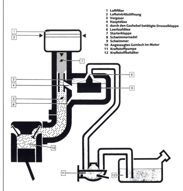
Luft und Kraftstoff werden vom Motor angesaugt. Eine Düse reguliert die Luftzufuhr, andere Düsen die Kraftstoffzufuhr. Damit die Dosierung bei allen Betriebsbedingungen die richtige ist, gibt es verschiedene Vorrichtungen.
