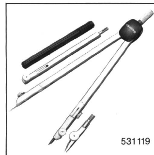
Besonders vielseitiger Einsatzzirkel, veloursvernickelt, mit Verlängerungsstange, Bleieinsatz, Reissfedereinsatz und -halter sowie Minendose. Beide Schenkel mit Gelenk, geeignet für das Blei- und Tuschezeichnen. Für Kreise bis \phi 580 mm
