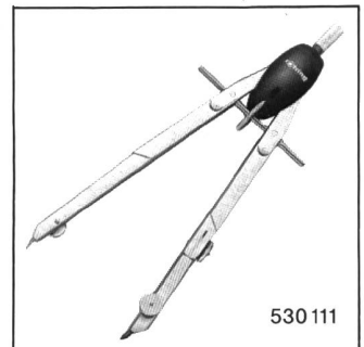
Teilzirkel mit Schnellverstellung, mattvernickelt, besonders zu empfehlen für feinmotorisch weniger begabte Schüler. Der einmal eingestellte Radius verändert sich nicht mehr, auch wenn der Zirkel zwischendurch abgelegt wird. Mit Bleieinsatz – kann gegen Tuschehalter ausgewechselt werden – und Minendose. Beide Schenkel mit Gelenk. Für Kreise bis \phi 320 mm
