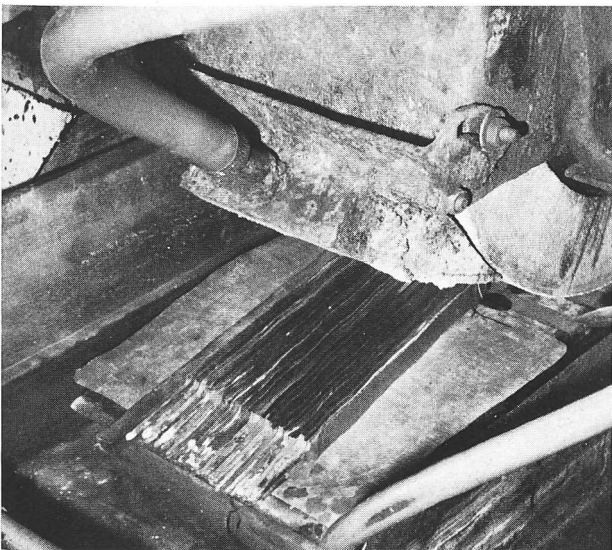
5a die Blattseiten mit der Schleifmaschine schleifen
