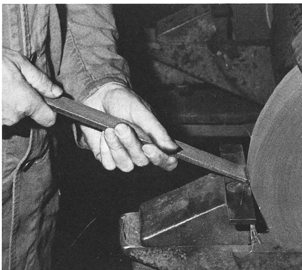
8b mit der Schleifmaschine abstossen
