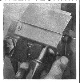
Handwerkzeug-Schleifmaschine Modell WSL für: **Stechbeitel** Handhobeleisen Lochbeitel, Falzkopfmesser, Fasmesser
