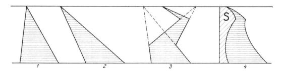
Warum sollen wir nicht die Horizontalstäbe, Streifen oder Höhenschnitte so verschieben, dass das Dreieck geknickt wird (Figur 3) oder sie an eine Schablone S herangeschoben denken? (Figur 4)
