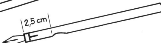
Abb. 16. Halter mit eingefeilter Delle für die Daumeneinlage. Strichmarke für richtigen Federeinsatz.
