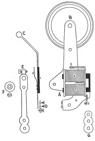
E. Unterbrecher: Wie erreichen wir einen selbsttätigen Stromunterbruch? Montieren des Unterbrechers (ohne Isolierscheiben).
