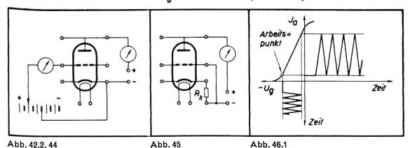
44. Da bei arbeitender Röhre zwischen der Gitterspannung und dem Anodenstrom eine lineare Funktion bestehen soll, wird eine Anfangsgitterspannung (= Gittervorspannung) so gewählt, dass sich der Anodenstrom bei jeder in der vorliegenden Schaltung möglichen Gitterspannung im linearen Bereich der Ja-Ug-Kennlinie bewegt. Dabei darf die Gitterspannung nie positiv werden, sonst würde ein Gitterstrom fliessen, und die Steuerung bliebe nicht mehr leistungslos.
