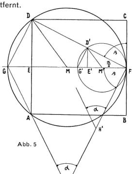
tragen. In H' (beliebig auf dem Schenkel FH) wird  $\alpha$  angetragen, und die Parallele durch A ergibt G und H.
