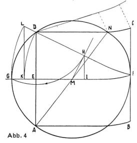
DF ist zu halbieren, der Kreis  $\left(M=D,\;r=\frac{DF}{2}\right)$  ist mit der Verlängerung von FE über E hinaus zu schneiden, DH = DG.
