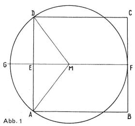
Mitte der Quadratseiten AD und BC. Alle Lösungswege führen durch Konstruktion oder Rechnung zur Bestimmung von M, r oder d = 2 r.
