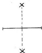
Abb. 7. Zirkelöffnung etwa \frac{3}{4} der Strecke gibt die schärfsten Schnittpunkte, rechtwinklig geschnittene Bogen
