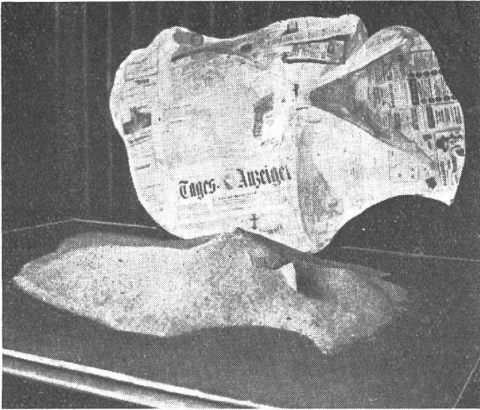
Abb. 1. Die Sandform der Insel, dahinter aufgestellt die eben abgehobene Kopie im Rohzustand (Ränder bereits beschnitten).
