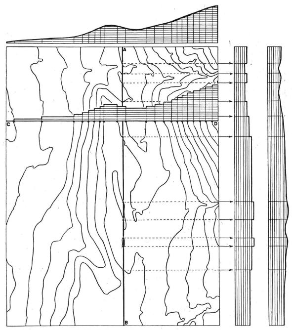
Abb. 4. A-B = Längsschnitt, C-D = Querschnitt (Kurvenbild aus dem Grundbuchübersichtsplan der Gemeinden Rorschach und Rorschacherberg)
