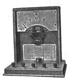
Im Bild: Demonstrations - Ampèremeter mit Trockengleichrichter für Wechselstrom, Niederund Tonfrequenz
