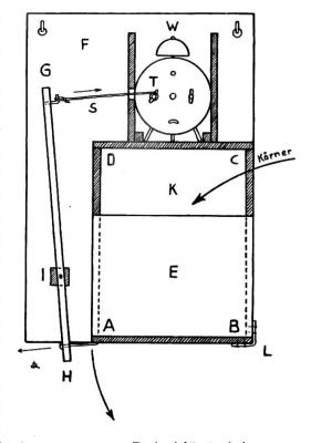
obere Ende des Hebels GH wird gegen den Wecker gezogen. Dabei löst sich der Stift vom Fallboden, und der Inhalt des Futterbehälters entleert sich, zur Freude der Hühner – und des Konstrukteurs.
