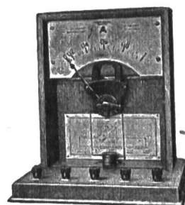
Im Bild: Demonstrations-Ampèremeter mit Trockengleichrichter für Wechselstrom, Nieder- und Tonfrequenz
