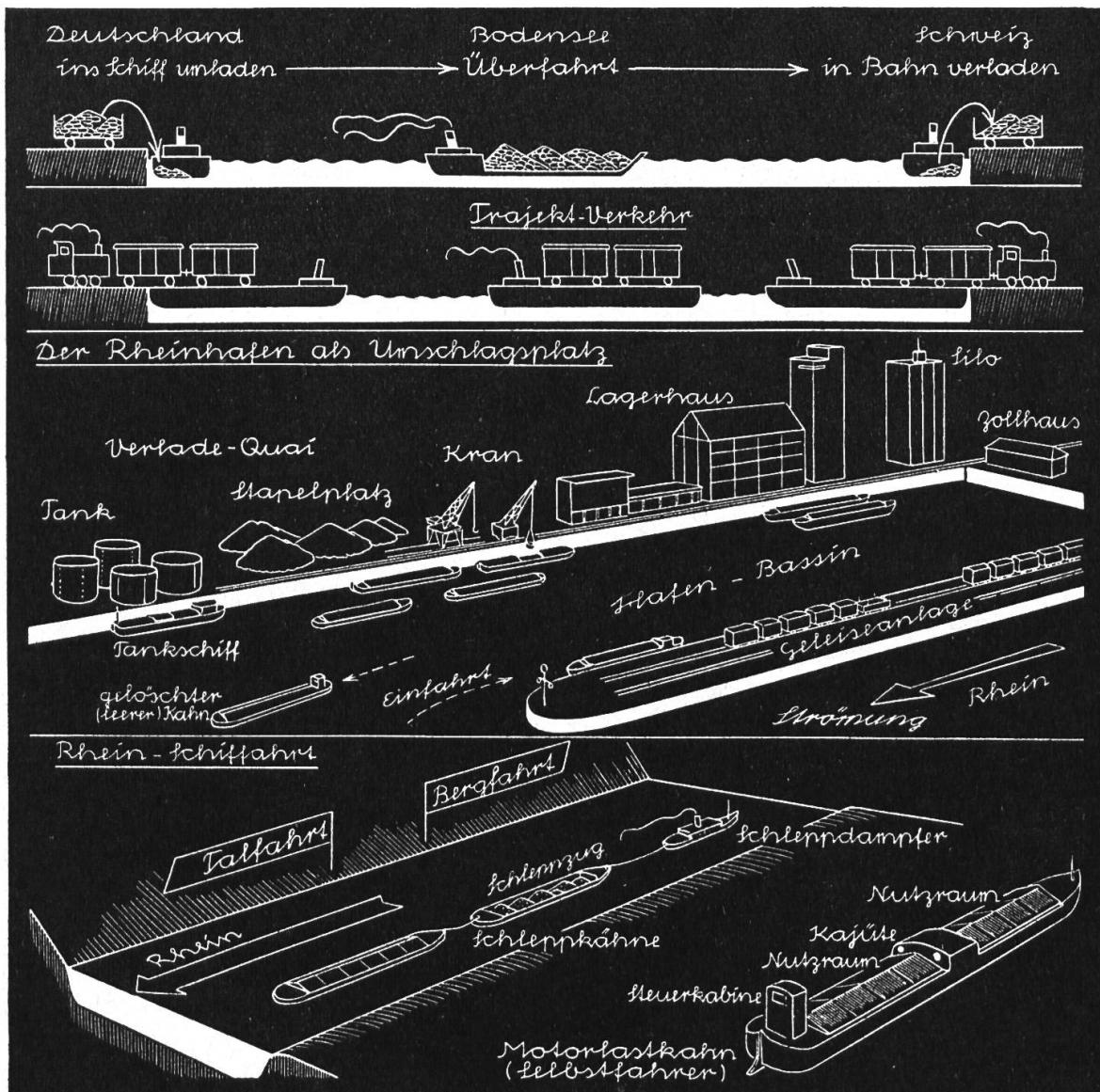
**Trajekt-Verkehr.** Bis vor wenigen Jahren auf dem Bodensee übliche Übersetzegelegenheit. Vergleich: Überführung von Waren in Schiffen, zweimaliger Umlad nötig. Trajektschiff nimmt beladene Wagen auf. Umlad unnötig. Umschlag auf dem Bodensee 1937 rund 200000 t Waren.
