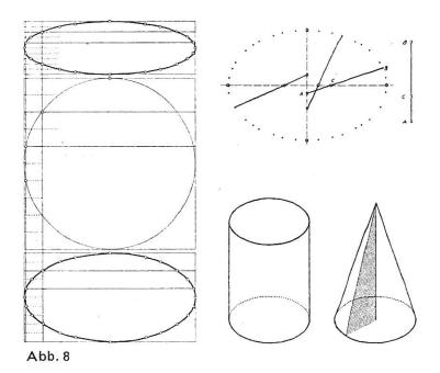
auf Zeichenpapierstreifen am Rande die halbe grosse Achse AB der Ellipse abzutragen, von B aus gegen A die halbe kleine Achse = Punkt C. Legen wir den Papierstreifen so auf das Achsenkreuz, dass A auf die Quer-, C auf die Längsachse zu liegen kommt, so bestimmt B einen Punkt der Ellipse, der mit dem Bleistift bezeichnet werden kann. Durch Verschieben der Punkte A und C auf den Achsen ergeben sich
