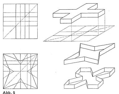
Holzkreuz. Grundrisszeichnung nach Abb. 5. Entsprechende Konstruktion im perspektivischen Grundriss. Die Abstände auf den verkürzten Seiten sind mit der Diagonale leicht zu finden.
