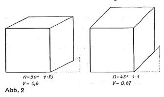
2. Aus einer Zeichnung nach Abb. 2 ist die Lage der beiden Würfel in Bezug auf die Augenhöhe des Beobachters abzuleiten. Winkel der ansteigenden Kanten 30° und 45°. Der Vergleich dieser Darstellung mit den Aufrissen der gleichen Körper erklärt den Ausdruck «Schrägbild».
