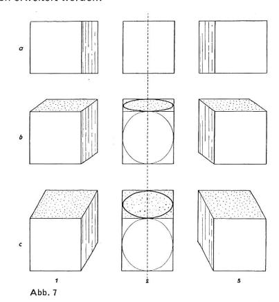
alle zu diesem Durchmesser parallelen Sehnen. Anwendung in einer Zeichnung (Abb. 8). Verkürzung beliebig. Die Konstruktion ist am einfachsten, wenn die Rechtecke unter oder über dem Quadrat mit dem eingeschriebenen Kreis angeordnet werden. Sie sind in gleich viele Streifen einzuteilen wie das Quadrat. Die Schnittpunkte der Kreislinie, mit den Parallelen auf das Rechteck übertragen, liefern die entsprechenden Punkte des perspektivischen Kreises, der Ellipse.
