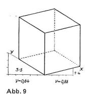
Steigungs- und Verkürzungsverhältnisse ermitteln wir wieder wie früher. Wandtafelbeispiel: vertikale Kante = 50 cm, Steigung: x-Achse 1: 4, y-Achse 3:5 (Abb. 9). Verkürzung mit der Klasse ausprobieren. Nachher sind 3 Würfel mit gegebenen Steigungen (1:5 / 2:5, 3:5 / 1:6, 1:3 / 1:4) auf ein Blatt zu zeichnen und die gefundenen Verkürzungen an der Wandtafel zusammenzustellen.
