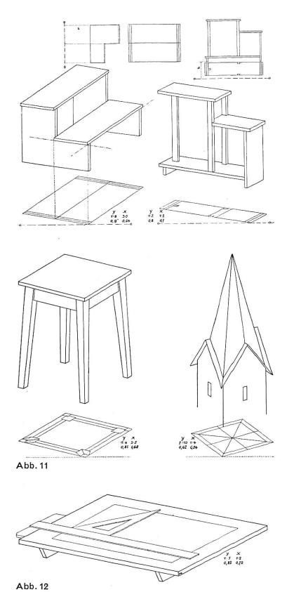
chenden Punkten des Grundrisses zu errichten. In gleicher Höhe liegende Punkte können auch durch Parallelen zu den Achsen ermittelt werden, siehe Abb. 11, ————Linien.
