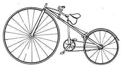
Abb. 9. Lawson-Fahrrad mit Kettenantrieb (Übersetzung)
