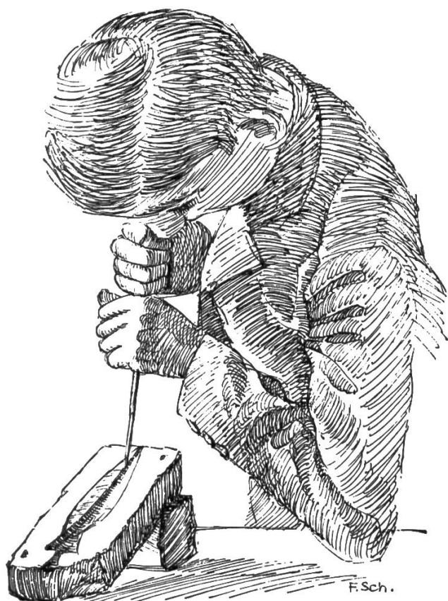
Abb. 4. Herstellung einer Gussform
