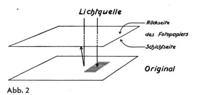
den weissen Flächen erfährt dadurch eine doppelte Belichtung: a) von der Rückseite und b) von den reflektierenden Stellen her. Die Schicht über den Schriftzeichen erhält nur die Belichtung durch die Rückseite (Abb. 2). Das fototechnische Papier ist nun
