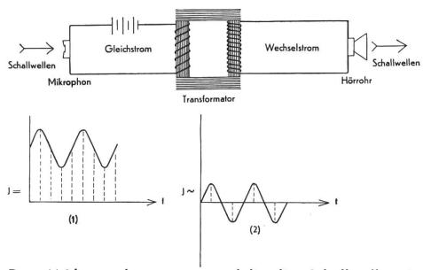
Das Mikrophon verwandelt die Schallwellen in Gleichstromschwankungen (1). Durch den Transformator erhalten wir auf der Sekundärseite die Stromänderungen um den Nullpunkt, d. h. als Wechselstrom (2). Gleichzeitig erhalten wir eine höhere Spannung entsprechend dem Übersetzungsverhältnis des Transformators. Das Hörrohr wandelt den Wechselstrom auf elektromagnetischem Wege wieder in Luftschwingungen um.
