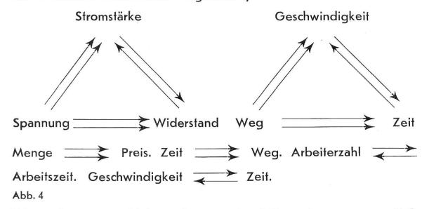
Warum hat man wohl für Lichtnetze eine höhere Spannung gewählt, als wir für unsere Versuche benutzten? Grosser Widerstand des ausgedehnten Netzes. Ströme noch höherer Spannung führen die Leitungen von den Elektrizitätswerken zu den Zentralen. Geringere Verluste als bei niederen Spannungen. Lichtnetz 145—220 Volt. Hochspannungsleitungen bis 8000 Volt.
