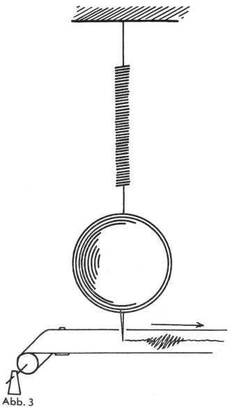
Schema eines (Horizontal) Seismographen
