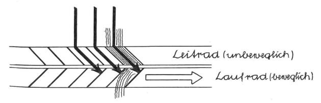
Das Leitrad ist unbeweglich. Es verändert die Richtung des nach unten fliessenden Wassers so, dass dieses ungefähr senkrecht auf die Schaufeln des beweglichen Laufrades fällt. Gute Ausnützung der Wasserkraft.
